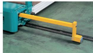
1 [OPEN] ボタンを押すとラックとアイルセンサーが同時に作動しますが、アイルセンサーはラックより前方にストローク通路内の障害物を監視します。
