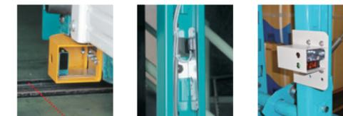
セーフティセンサー (レール式・レールレス) 進入センサー (レール式) 進入センサー (レールレス)
