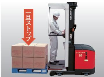
下降ボタンを押し続けても、パレットが接地する前に一旦停止しますので、意図しないパレット抜けが防止できます。(もう一度下降ボタンを押すと最低位置までリフトダウンします。)
